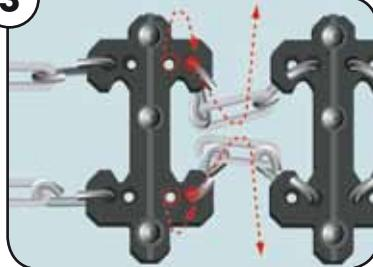
**F** Ajustement de la chaîne (allongement possible jusqu'au 220 mm - taille XXXL jusqu'au 300 mm)
